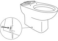
ควรยึดโถสุขภัณฑ์ด้วยชุดอุปกรณ์ยึดขาฐาน Installing bowl with floor mounting kit is recommended
