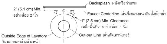
**2** Drill pilot hole and cut the countertop opening. ตัดรูเจาะตามรอยบนเคาน์เตอร์
